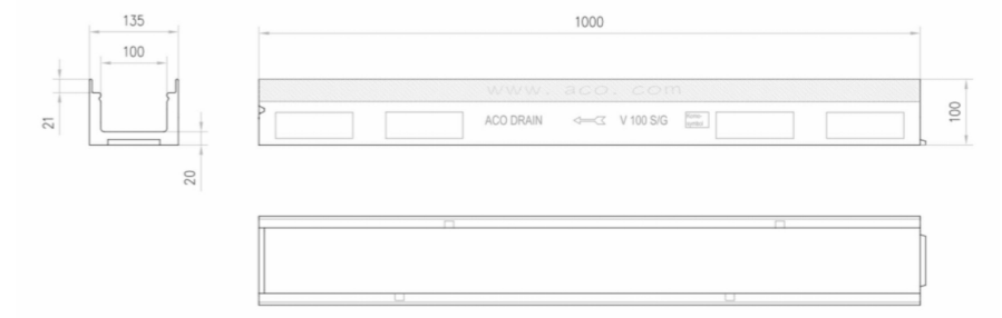
CANALES DE DRENAJE ACO DRAIN - MULTIDRAIN 100 CNL MD 100 BA 1000MM H100 DN/OD 110 D400
