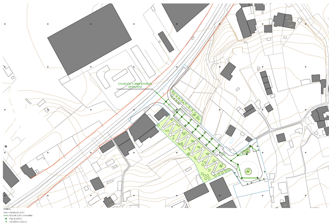
Figura nº06. Rede de saneamento de augas pluviais.
