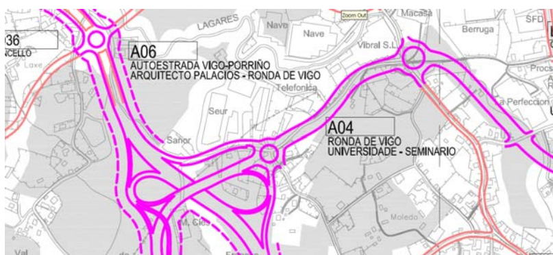
Plano do PXOM de sistema xeral viario: En magenta os SX de primeira categoría e en laranxa (Estrada de Moledo), o sistema xeral viario de segunda categoría (estructurante)
